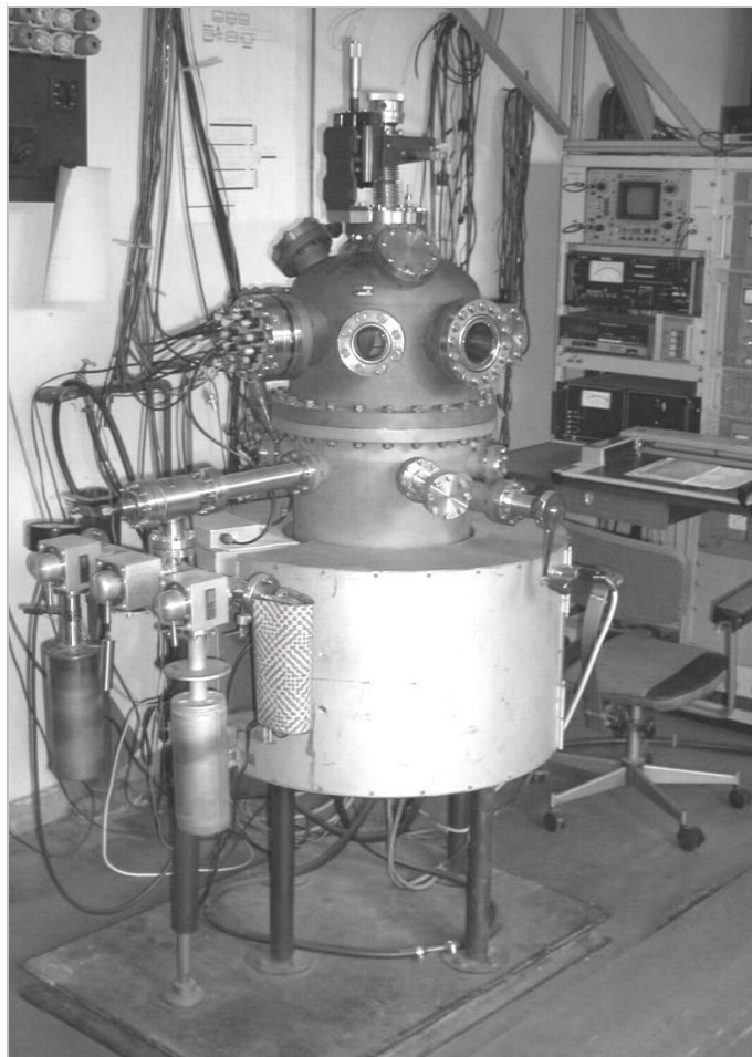
Rys. 18. Spektrometr elektronów Augera (koniec lat 80.). Jednostka pompowa wykonana w ZAP w Bolesławcu, manipulator produkcji OBREP
