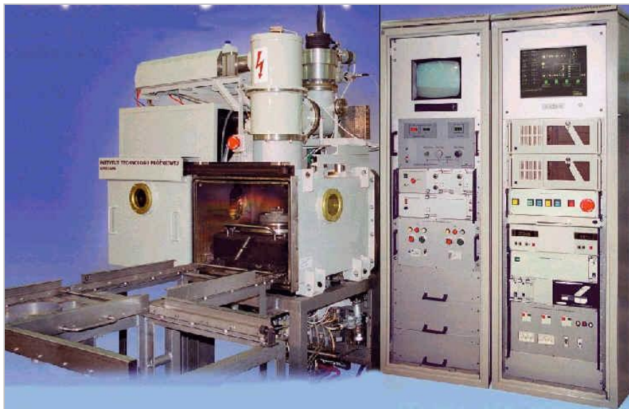
Rys. 13. Ogólny widok spawarki elektronowej 60 kV / 3 kW. Wdrożenie: Zakłady Pratt and Whitney, Ropczyce, 2002 r. (Opracowano w Przemysłowym Instytucie Elektroniki w Warszawie, przy współpracy – w zakresie zasilacza wysokonapięciowego – Wydziału Elektroniki Mikrosystemów i Fotoniki Politechniki Wrocławskiej)
