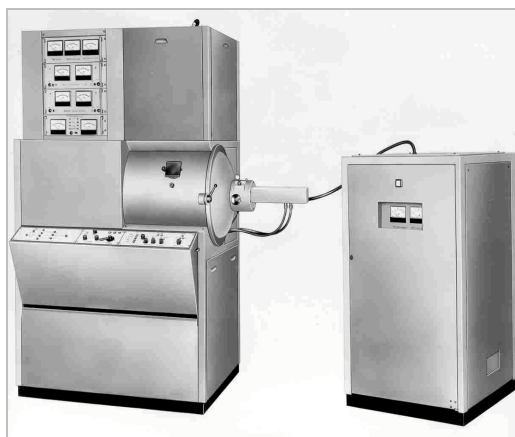
Rys. 8. Piec elektronowy do topienia metali 10 kW/25 kV. (Opracowano w ówczesnym Oddziale Wrocławskim Przemysłowego Instytutu Elektroniki)
