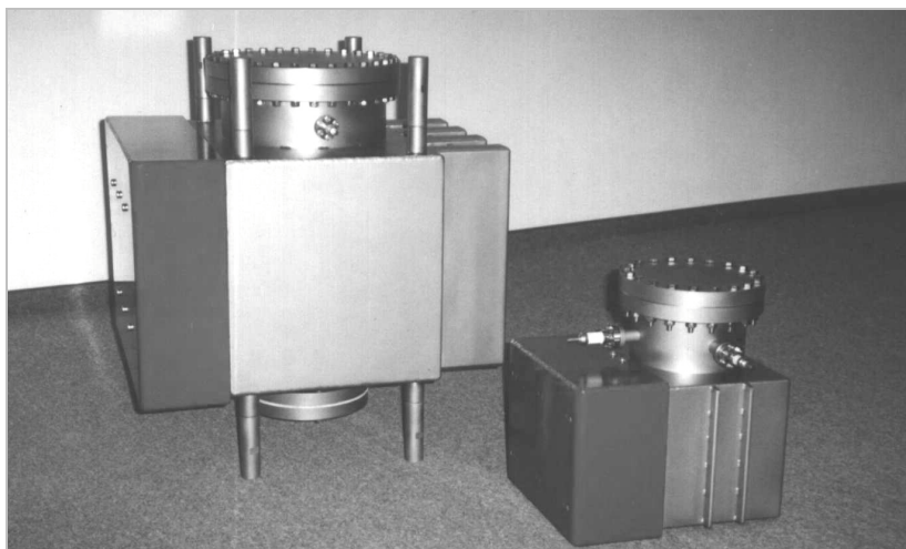
Rys. 5. Rodzina pomp jonowo-sorpcyjnych z zimnymi katodami opracowana w ITP. w końcu lat 90. w ramach PBZ
