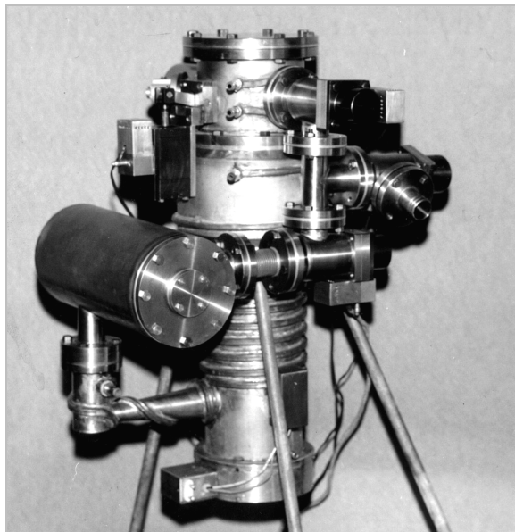
Rys. 10. Układ pompowy UP800 skonstruowany w ITE Politechniki Wrocławskiej
