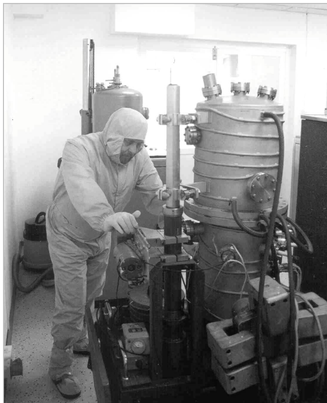
Rys. 12. Pierwsza napyłarka wysokiej i czystej próżni wdrożona w ZAP
