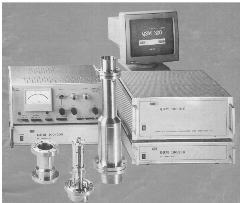
Rys. 6. Rodzina spektrometrów kwadrupolowych (opracowanie ITP z 1994 r.)
