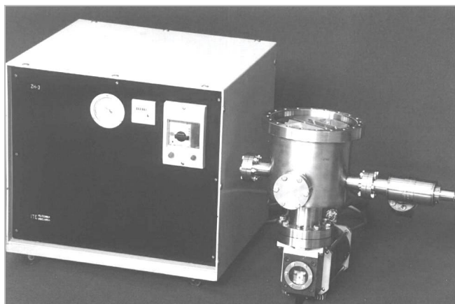
Rys. 3. Chłodziarka i kriopompa opracowana w Zakładzie Techniki Próżni Politechniki Wrocławskiej w latach 90.
