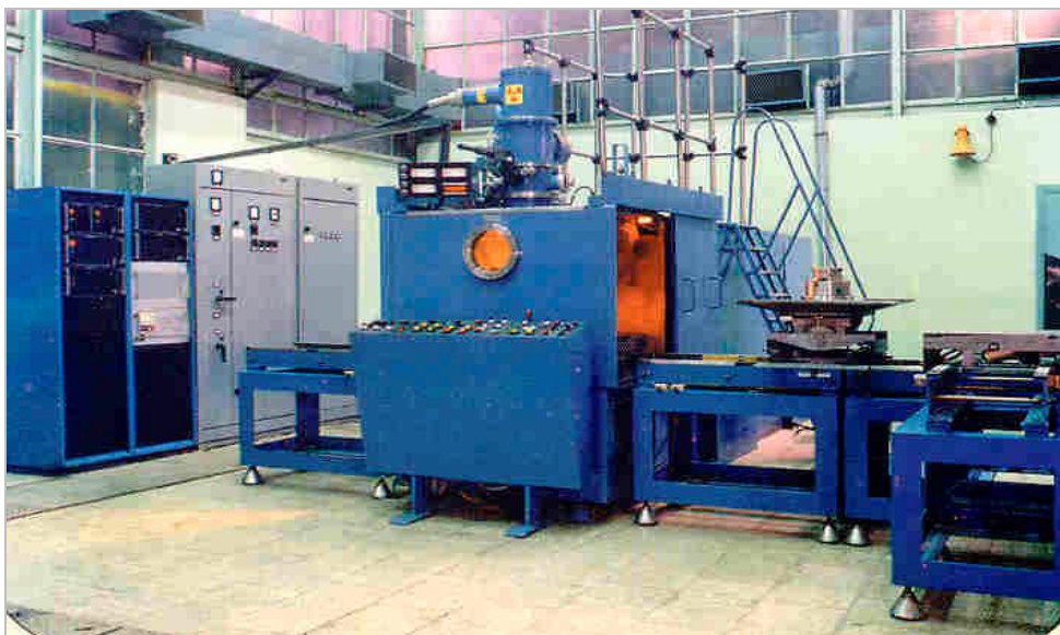
Rys. 11. Wysokonapięciowa uniwersalna spawarka elektronowa typu SE10/60 (Opracowano w Instytucie Technologii Elektronowej Politechniki Wrocławskiej)
