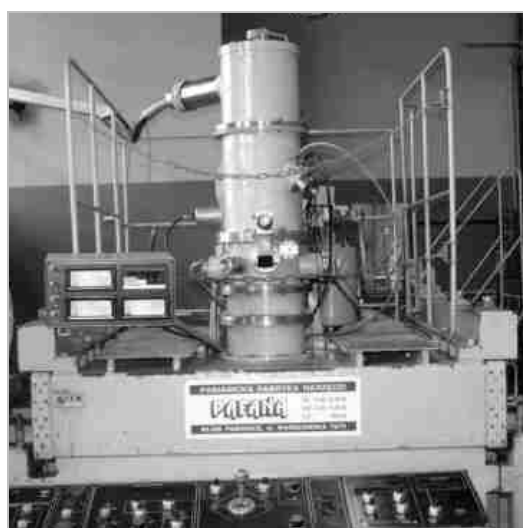
Rys. 11. Wysokonapięciowa uniwersalna spawarka elektronowa typu SE10/60 (Opracowano w Instytucie Technologii Elektronowej Politechniki Wrocławskiej)
